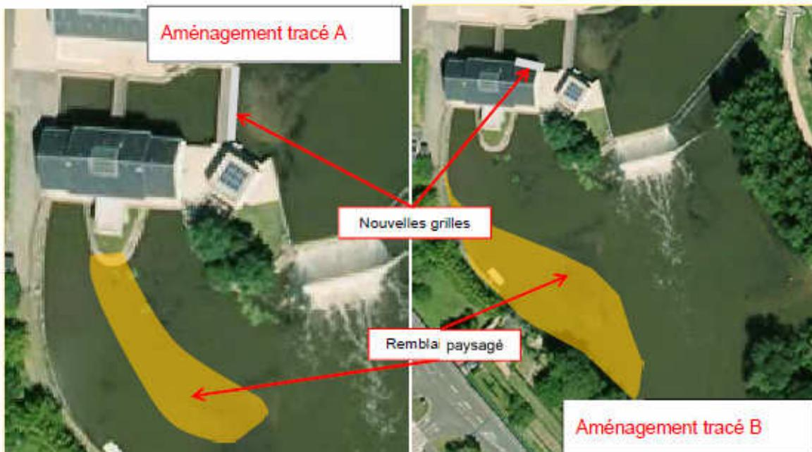
Figure 4-15 : Implantation possible des passes à poisson
